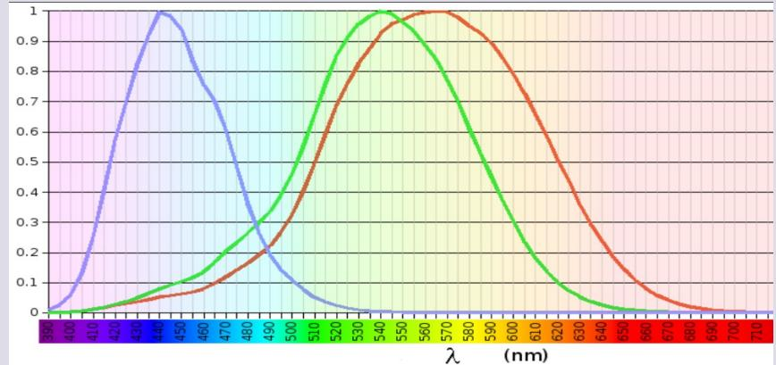
La couleur d'un objet provient de la superposition des radiations non absorbée de la lumière blanche. On voit donc la couleur complémentaire des couleurs absorbées par l'objet (ex : une armoire vue jaune absorbe le bleu).
