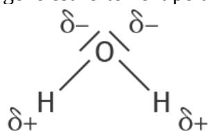
La molécule d'eau est coudée. Les polarisations de ces liaisons ne se compensent pas, on en déduit que la molécule d'eau est polaire.
