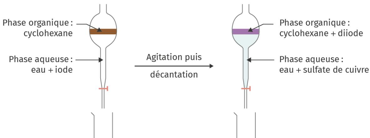
Avant agitation, la phase organique (cyclohexane pur), qui se trouve au dessus, est incolore. La solution aqueuse est de couleur marron (mélange d'orange, couleur du diiode en solution aqueuse et de bleu, couleur du sulfate de cuivre).
