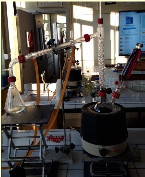
Remplir le ballon à moitié et l'ampoule de coulée avec du permanganate de potassium.
