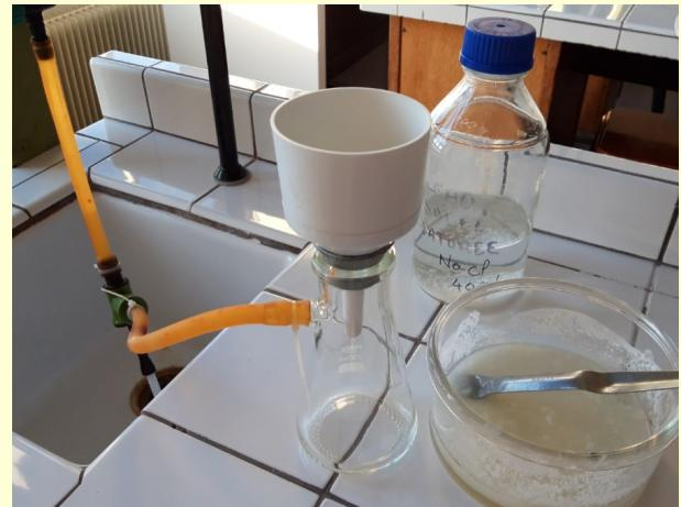
Dans le ballon, introduire 50 ml d'huile, 30 mL de soude concentrée et 60 mL d'éthanol pur et quelques grains de pierres ponce. Chauffer une demie heure puis effectuer le relargage dans un cristallisoir avec 140 mL d'eau salée saturée. Filtrer sur Büchner et laisser sécher jusqu'au durcissement. Expliquer le rôle des montages et de chaque étape.
