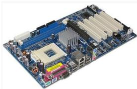
**carte mère :** circuit imprimé supportant les composants et connecteurs nécessaires au fonctionnement d'un PC
