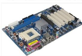
**carte mère :** circuit imprimé supportant les composants et connecteurs nécessaires au fonctionnement d'un PC
